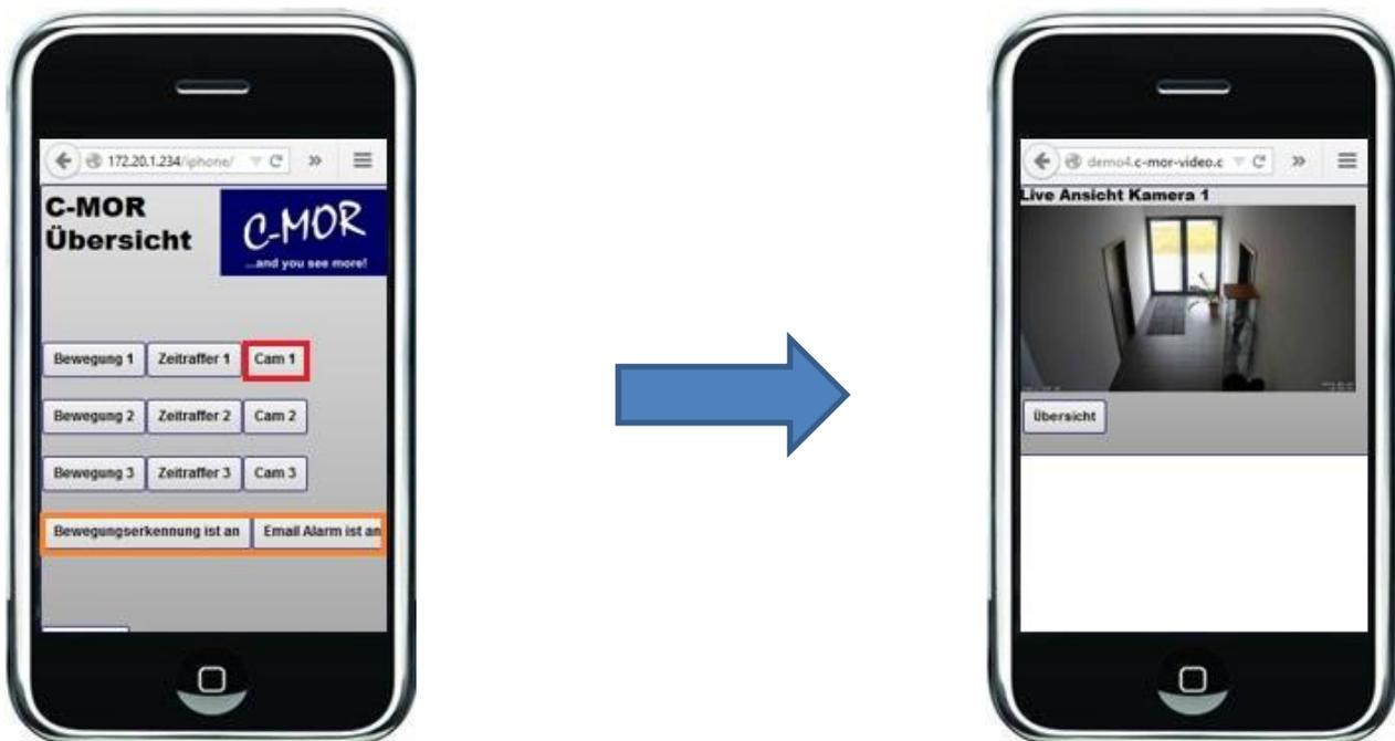
Wird der Button „Bewegung <Kamera>“ angeklickt, so werden die Aufnahmen der Bewegungserkennung aufgelistet. Unter „Zeitraffer <Kamera>“ die Aufnahmen der Daueraufzeichnungen.
