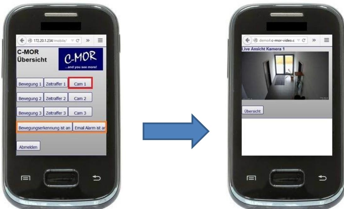
Wird der Button „Bewegung <Kamera>“ angeklickt, so werden die Aufnahmen der Bewegungserkennung aufgelistet. Unter „Zeitraffer <Kamera>“ die Aufnahmen der Daueraufzeichnungen.
