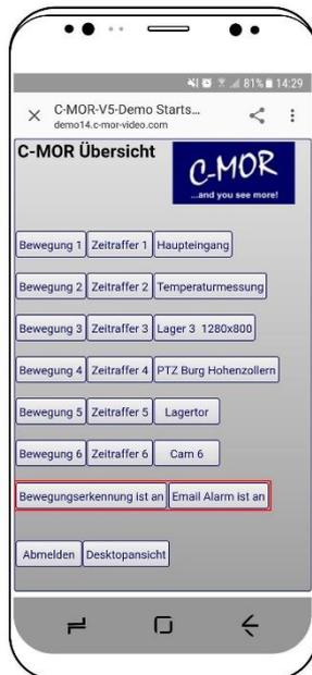
Wird der Button „Bewegung <Kamera>“ angeklickt, so werden die Aufnahmen der Bewegungserkennung aufgelistet. Unter „Zeitraffer <Kamera>“ die Aufnahmen der Daueraufzeichnungen.
