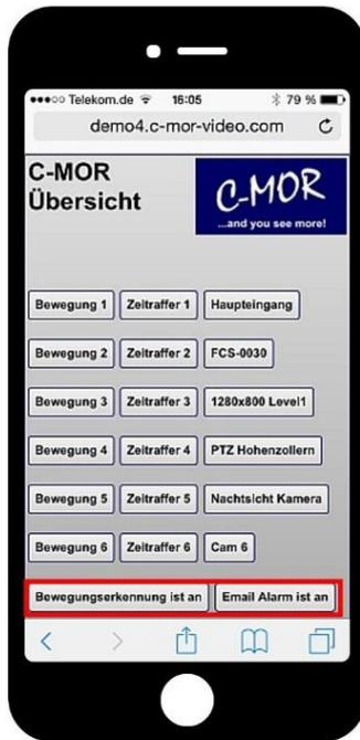
Wird der Button „Bewegung <Kamera>“ angeklickt, so werden die Aufnahmen der Bewegungserkennung aufgelistet. Unter „Zeitraffer <Kamera>“ die Aufnahmen der Daueraufzeichnungen.
