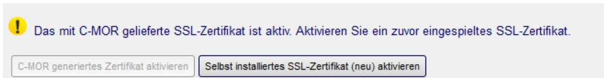
Zum Schluss muss das hochgeladene Zertifikat aktiviert werden. Klicken Sie hierzu auf den Button „Selbst installiertes SSL-Zertifikat (neu) aktivieren“. Es erscheinen danach folgende Meldungen:
