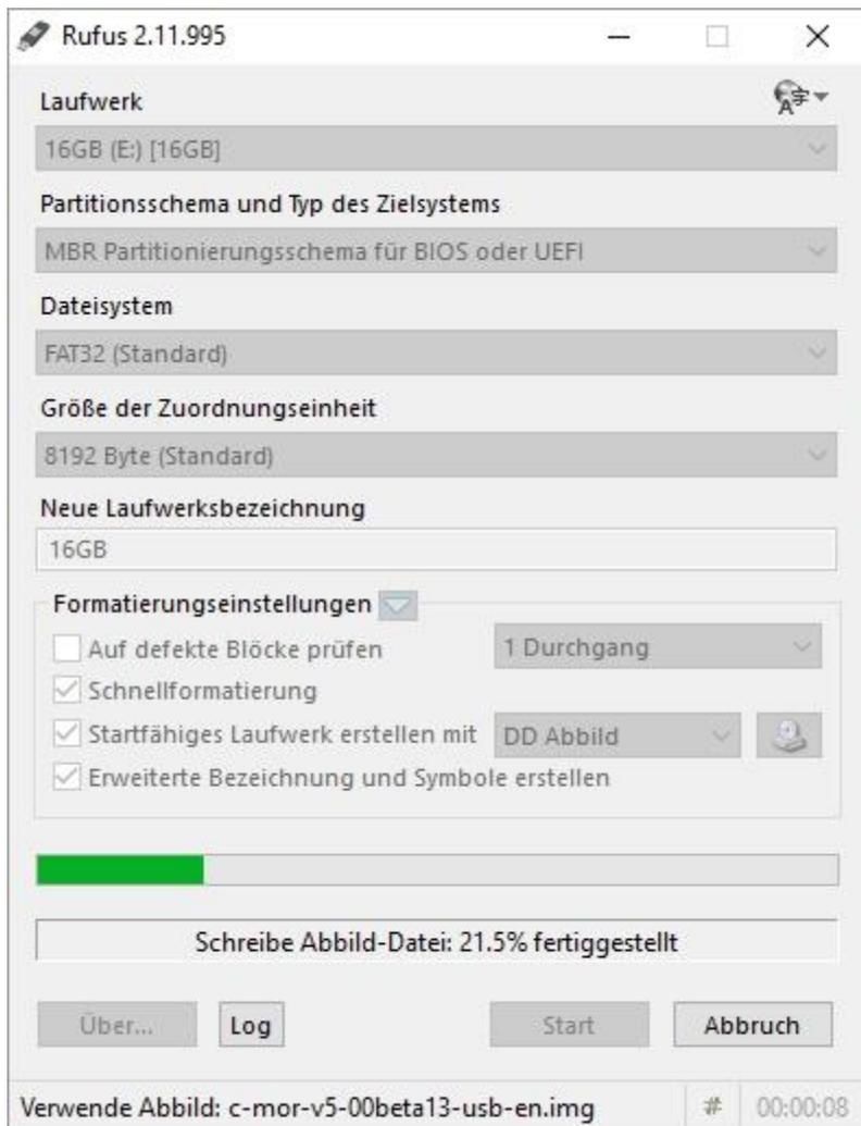
Ist der Schreibvorgang abgeschlossen, wird der Stick in den PC gesteckt, auf dem C-MOR direkt installiert werden soll und vom USB-Stick gebootet. Hat alles geklappt dann erscheint jetzt das C-MOR Installationsprompt.
