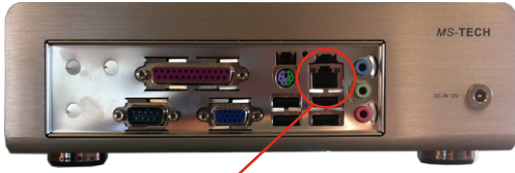
LAN1 für Netzwerk-Anbindung (Switch)
